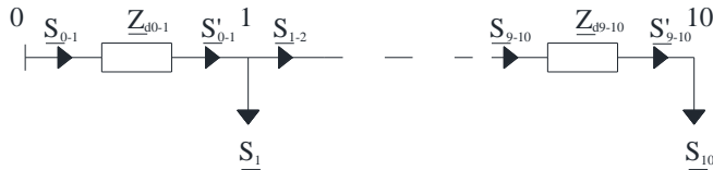
Hình 14: Sơ đồ thay thế khi tính lưới điện hạ áp 1 pha
