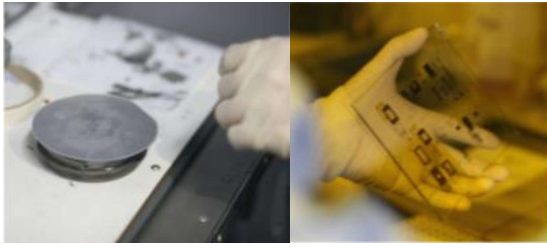
Hình 5. Chế tạo điện cực Al trên nền AlN/Si
