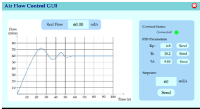
Hình 13: Giao diện phần mềm điều khiển lưu lượng bơm lấy mẫu.
