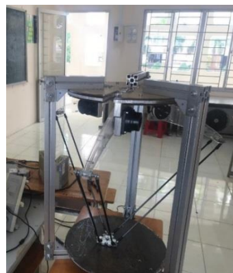
Hình 12: Ứng dụng giải thuật điều khiển thông minh trên hệ thực nghiệm Delta robot 3-DOF phiên bản 3
