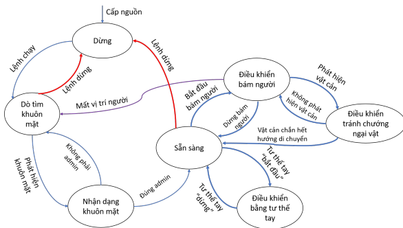
Hình 10. Điều khiển phối hợp các chế độ vận hành xe
